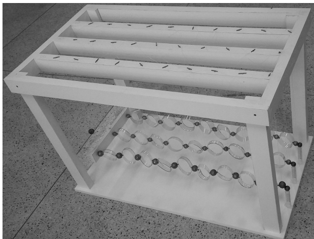
Figura 1: Réplica do aparato constituído por chumbadas de pesca suspensas e conectadas por anéis de garrafa PET, denominado simulador de propagação de ondas mecânicas em meios sólidos [1]. Fileira 1 ao fundo e fileira 3 à frente.
